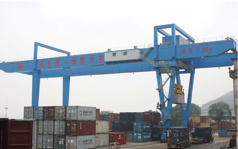
珠江船务采用电动龙门起重机及具变频驱动器的桥式起重机，以减低能源消耗，从而减少相关的空气及温室气体排放
